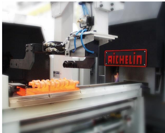
Abbildung 6: Roboter zum Fixturhärten von Automobilteilen (Bild AICHELIN)
