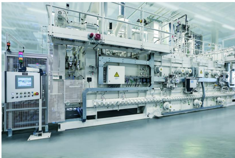
Abbildung 9: In den Fertigungsfluss integrierte AICHELIN-Nitrieranlage
