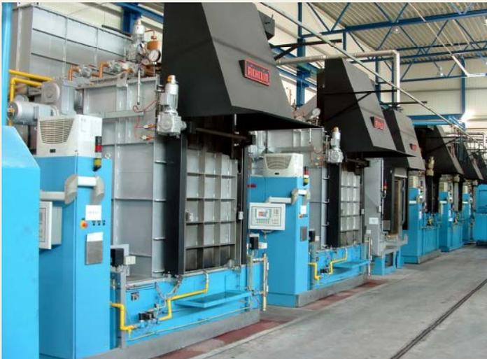
**BILD 3:** Mehrzweck-Kammerofenanlage
