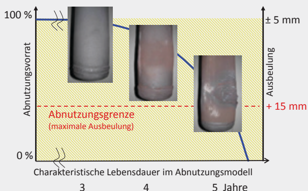
Bild 6: Abnutzungsmerkmal: Ausbeulung eines Strahlheizrohrs
