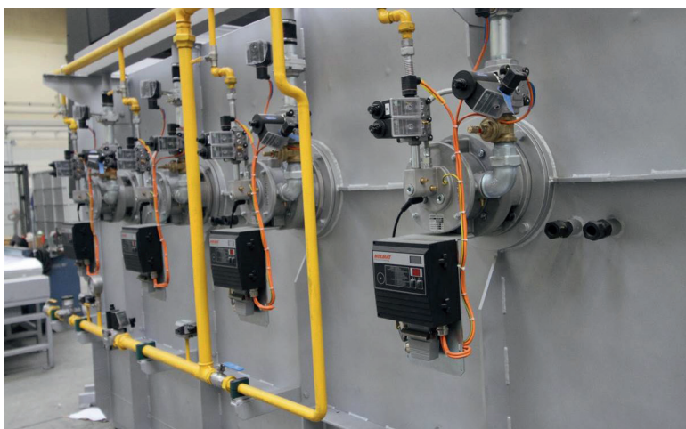
Bild 4: Flammenbrenner Typ NOXMAT FB 80-250 mit redundanten Gasventilen
